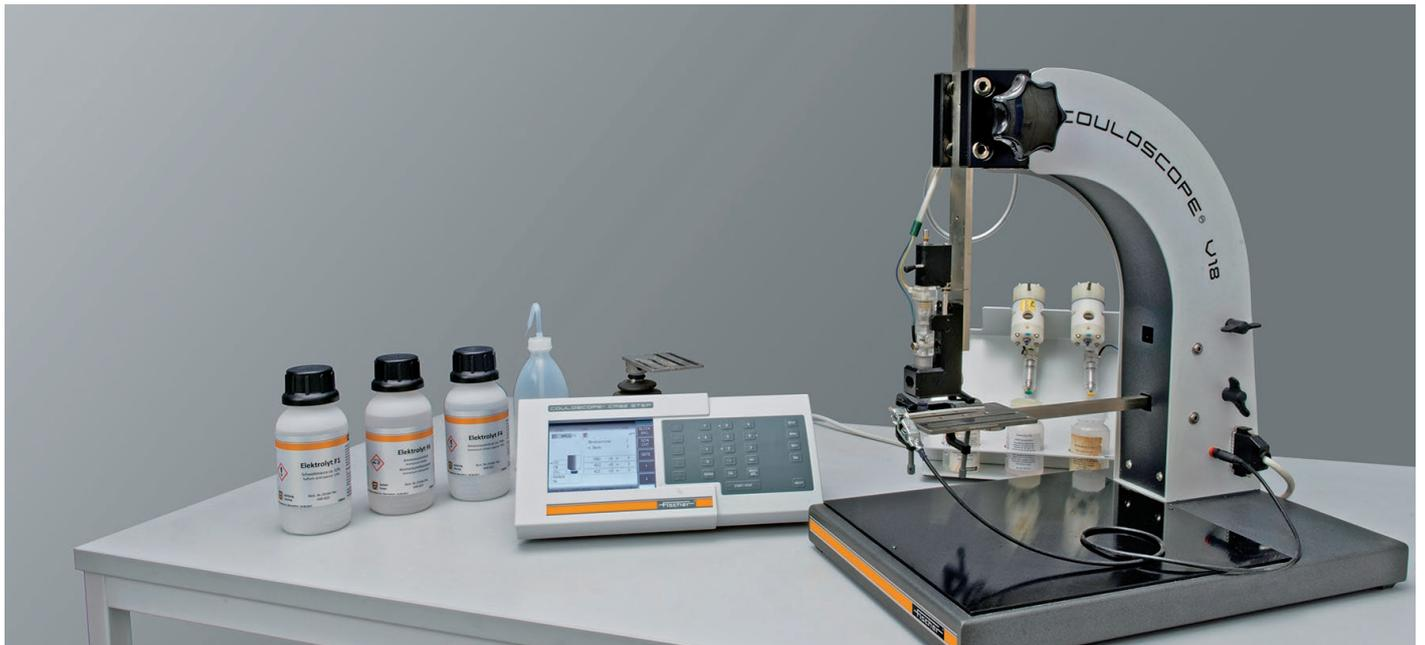
COULOSCOPE CMS2 をV18測定スタンドに設定した測定セット
